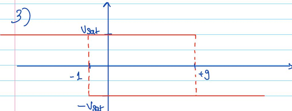
On retrouve le comportement caractéristique d'un comparateur à hystérésis, mais décalé de  $\frac{2}{3} V_0$ .
