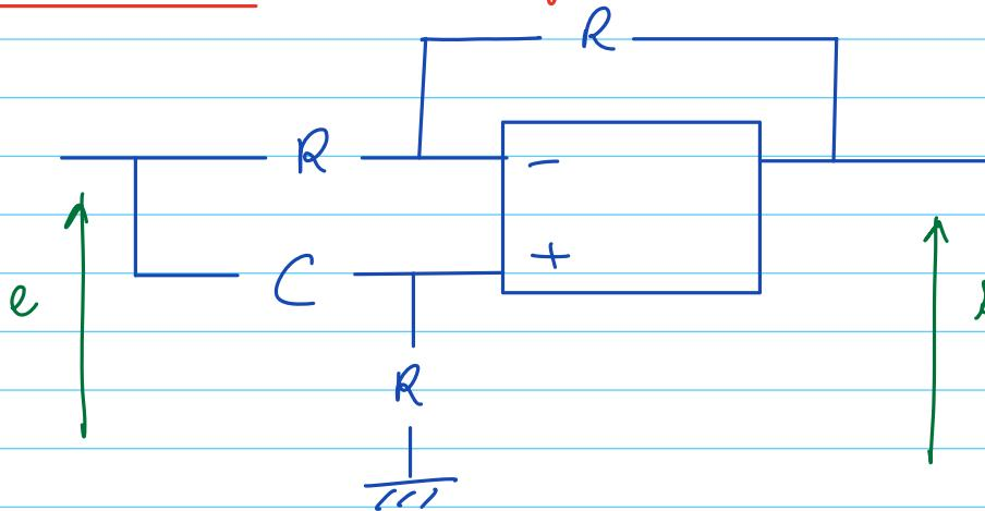
1) En basses fréquences, le circuit est équivalent à :
